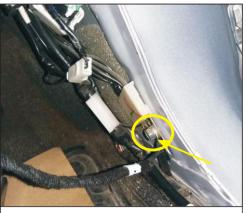
11. 找到接地螺丝, 连接我司地线
